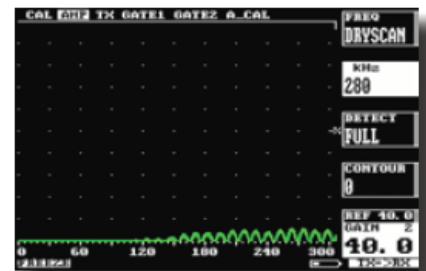
Oblast s defektem – špatný kus
